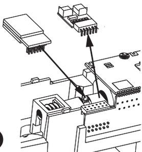
**(DE)** Zum Einbau eines PluX12-Decoders nach NEM 658 wird der Entstörsatz mit dem Adapterleiterplatte abgezogen. Danach kann ein PluX12-Decoder eingesteckt werden.
