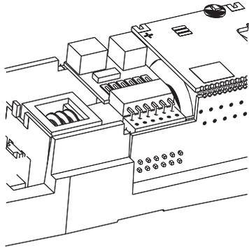
**(DE)** Für eine Digitalisierung gibt es im Modell eine PluX12-Schnittstelle. Wir empfehlen die Verwendung eines Decoders PluX12 von Uhlenbrock (TILLIG Art.-Nr. 66035). Zum Einbau des Decoders ist das Oberteil entsprechend der Anleitung auf Seite 1 abzunehmen. Quer in der Rahmenseitung befindet sich die Decoderschnittstelle.
