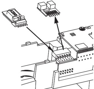
**(DE)** Zum Einbau eines Decoders nach NEM 651 S klein wird nur der Entstörsatz abgezogen. Danach kann ein Decoder nach NEM 651 S klein eingesteckt werden. Hierfür empfehlen wir den Decoder von Uhlenbrock (TILLIG Art.-Nr. 66032).
