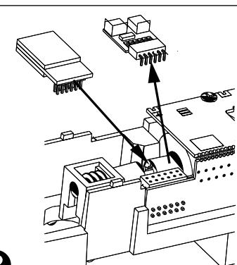
(DE) Zum Einbau eines PluX12-Decoders nach NEM 658 wird der Entstörsatz mit dem Adapterleiterplatte abgezogen. Danach kann ein PluX12-Decoder eingesteckt werden.
