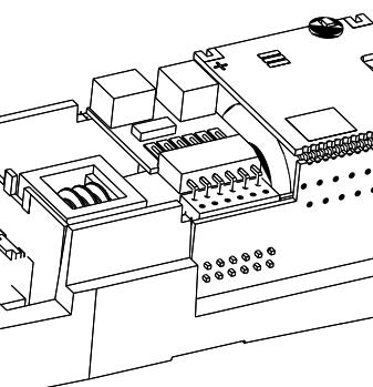
(DE) Für eine Digitalisierung gibt es im Modell eine PluX12-Schnittstelle. Wir empfehlen die Verwendung eines Decoders PluX12 von Uhlenbrock (TILLIG Art.-Nr. 66035). Zum Einbau des Decoders ist das Oberteil entsprechend der Anleitung auf Seite 1 abzunehmen. Seitlich in der Rahmennäussparung befindet sich die Decoderschnittstelle.
