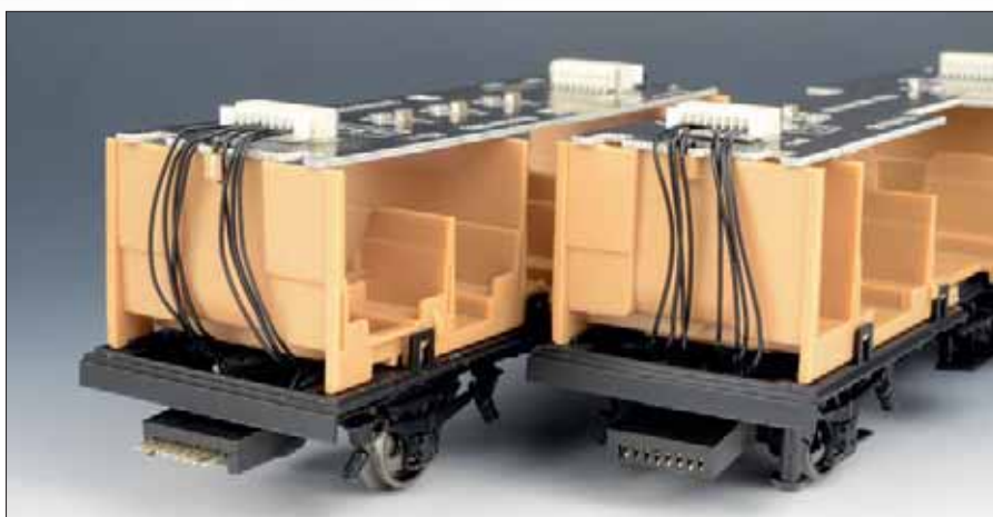
Die Gehäuse halten durch Rastnasen auf den Fahrwerken und sind folglich ohne Schrauben lösbar, sodass der Innenraum mit Fahrgästen bestückt werden kann. Dünne Kunststoffplatten sichern und schützen die beiden stromführenden Kupplungen.
