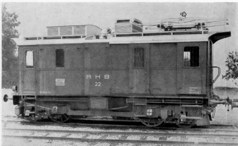
Abb. 3. Das Vorbild der heutigen Bauanleitung, die Gepäcklok DZeh 2/4 Nr. 22 der RHB. Man erkennt, daß auf der „Bergseite“ (rechts) das Vordach und der Stromabnehmer über die Pufferebene hinausragen. An dieser, im Betrieb stets der vorgestellten Wagengarnitur zugewandten Front fehlen sogar die Spitzensignale; umgekehrt sind an der Führerstandsseite (links) keine Brems- und Heizkupplungen vorgesehen (vgl. Abb. 4 u. 5).
