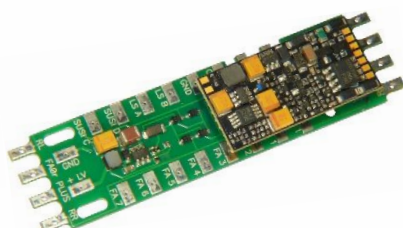
ADAPUS15 mit ZIMO Sound-Decoder MX645P22, 71 x 18 x 7,8 mm
