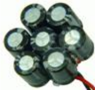
GoldCap-Module mit 7 GoldCaps (7 x 1F in Serie, also 140000µF / 17,5 V)
