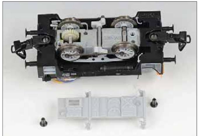
Nach Abschrauben der Bodenplatte wird das einfache Antriebsprinzip sichtbar. Auffällig auch hier die etwas kräftigen Spurkränze. Schade, dass die kleine Rangierlok keine Kurzkupplungskulissen erhalten hat.
