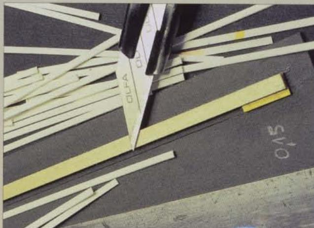
Die Schneidlehre für die Balkenimitation, Breite der Streifen 1,5 mm. Unten im Bild die Ziehklänge, die zur Führung des Schnitts mit dem Cutter dient.
