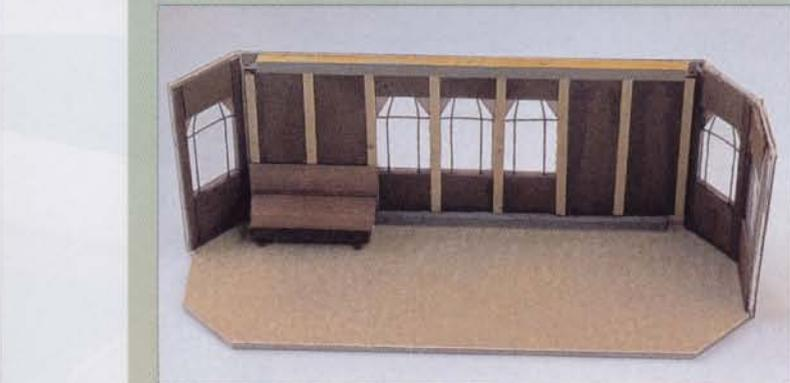
Die Fenster sind eingesetzt, die Rahmung an der Außenseite bis auf die Messingstreifen komplett, die Außenhaut von innen verstärkt bis zur Innenfläche des Fensterfilms.
