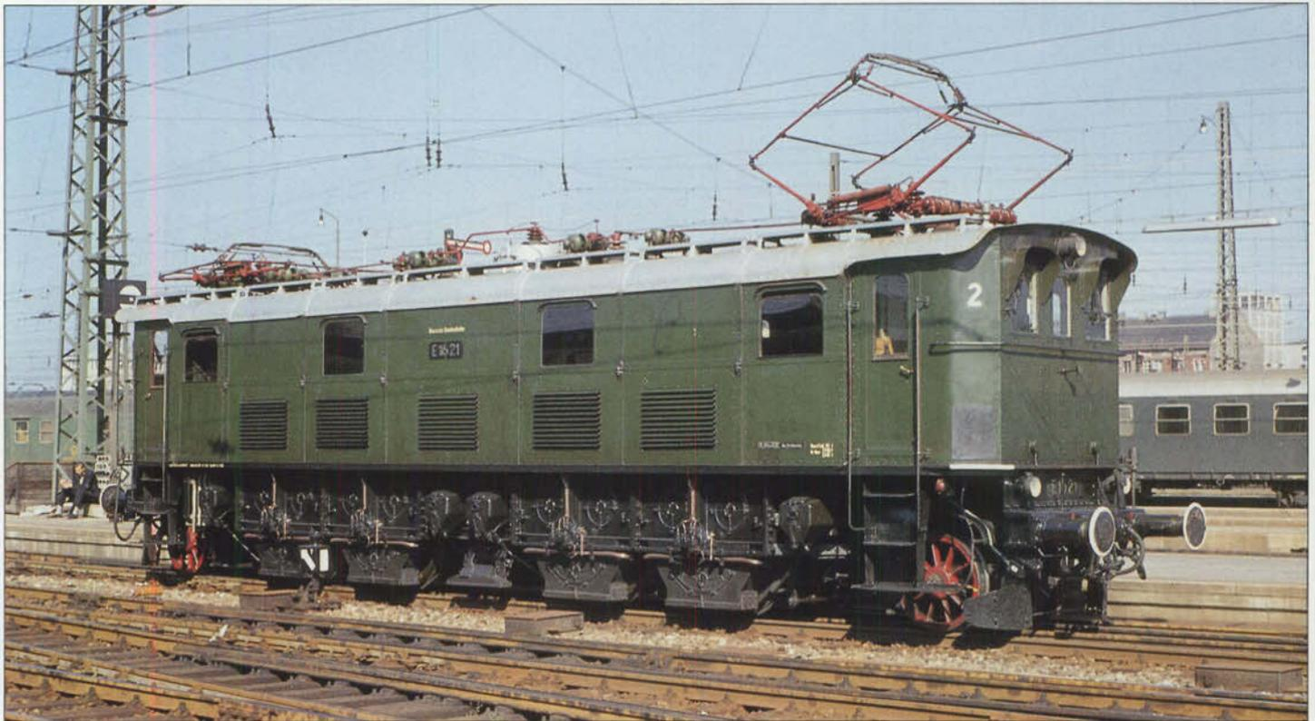
Ende des Zweiten Weltkriegs besonders große Schäden erlitten hatten, standen der Deutschen Bundesbahn noch 19 Fahrzeuge zur Verfügung, die in der Zeit von 1948 bis 1951 bei BBC und Krauss-Maffei einer Hauptausbesserung unterzogen wurden. Im Rahmen der Instandsetzungen wurden bei den Lokomotiven der Baureihe E 16 die Stirnwandtüren und die Übergangseinrichtungen entfernt, bei der Reihe E 16' der charakteristische Rahmen an der Antriebsseite.
