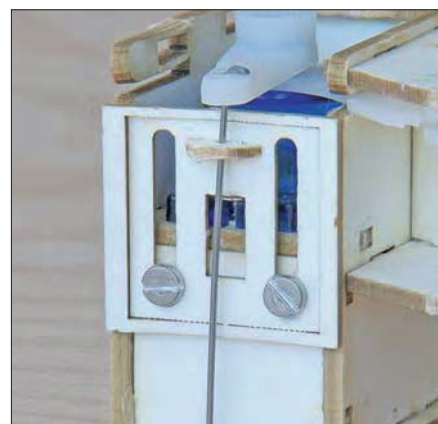
Ein Tipp zur Verlängerung des Stellwegs – sofern erforderlich: Die Schrauben der Justierplatte lösen und diese einfach auf den Kopf stellen. Durch diese Maßnahme erhöht sich der Stellweg auf knapp 1 cm.
